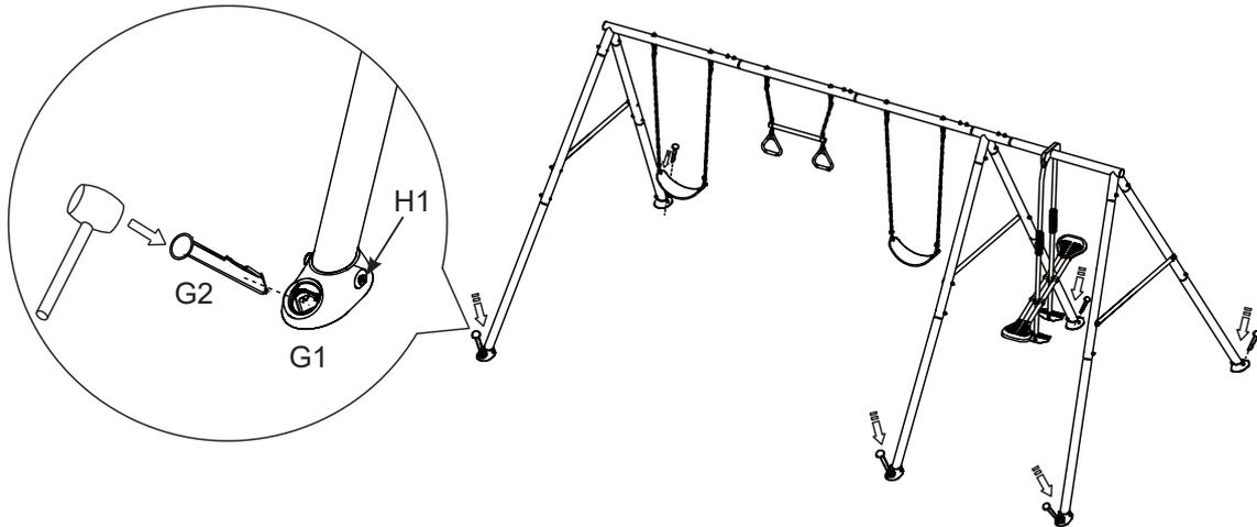
1. Fije las bases de los pies de anclaje en hormigón (no incluido). Nivele el conjunto de columpios y marque las ubicaciones de las bases de los pies de anclaje. Cave agujeros de 30 cm (11,8 pulgadas) de diámetro por 35 cm (13,8 pulgadas) de profundidad.
