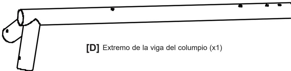
[D] Extremo de la viga del columpio (x1)
